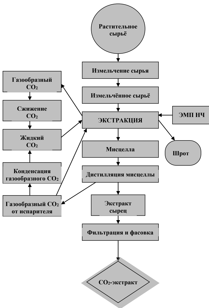
Рисунок 15 – Схема производства СО 2 -экстрактов
